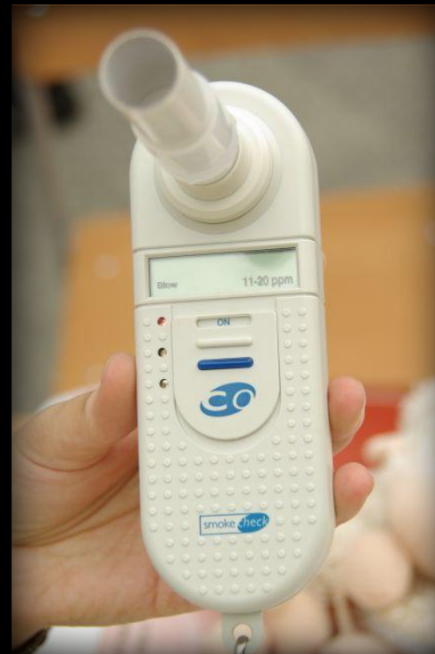
„Smoke-Check” – miernik zawartości tlenku węgla w wydychanym powietrzu u palaczy tytoniu
